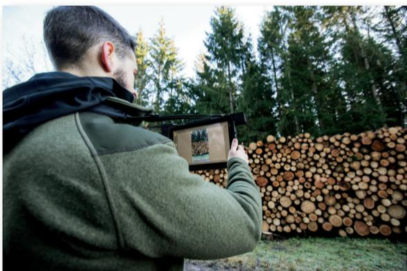
**Poltervermessung:** Der Vermesser kann die registrierten Polter am Messgerät sehen und den zu vermessenden Polter aussuchen.
